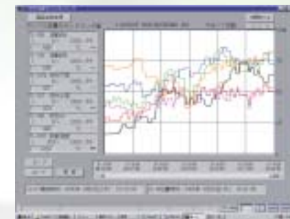
▲ヒストリカルトレンド画面 プラント状況把握のため、時間軸を長くとり、過去から現在までのトレンドデータをグラフに表示します。6点/1画面で最大20画面まで表示でき、合計120点分のヒストリカルトレンドデータが表示できます。
